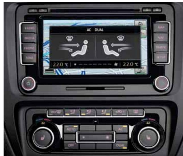
El **climatizador Bi-zona Climatronic** permite seleccionar la regulación de la temperatura para el conductor y el acompañante de forma individual. Los embellecedores cromados crean una exclusiva estética. | **O|S**
