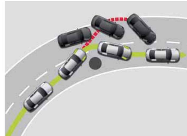
El **programa electrónico de estabilidad ESP con asistente de contravolante** impide que el vehículo se desvíe de su trayectoria en las situaciones de marcha críticas, interviniendo de forma selectiva en la gestión de los frenos y del motor. De este modo, el vehículo goza de una estabilidad direccional máxima. | **A**
