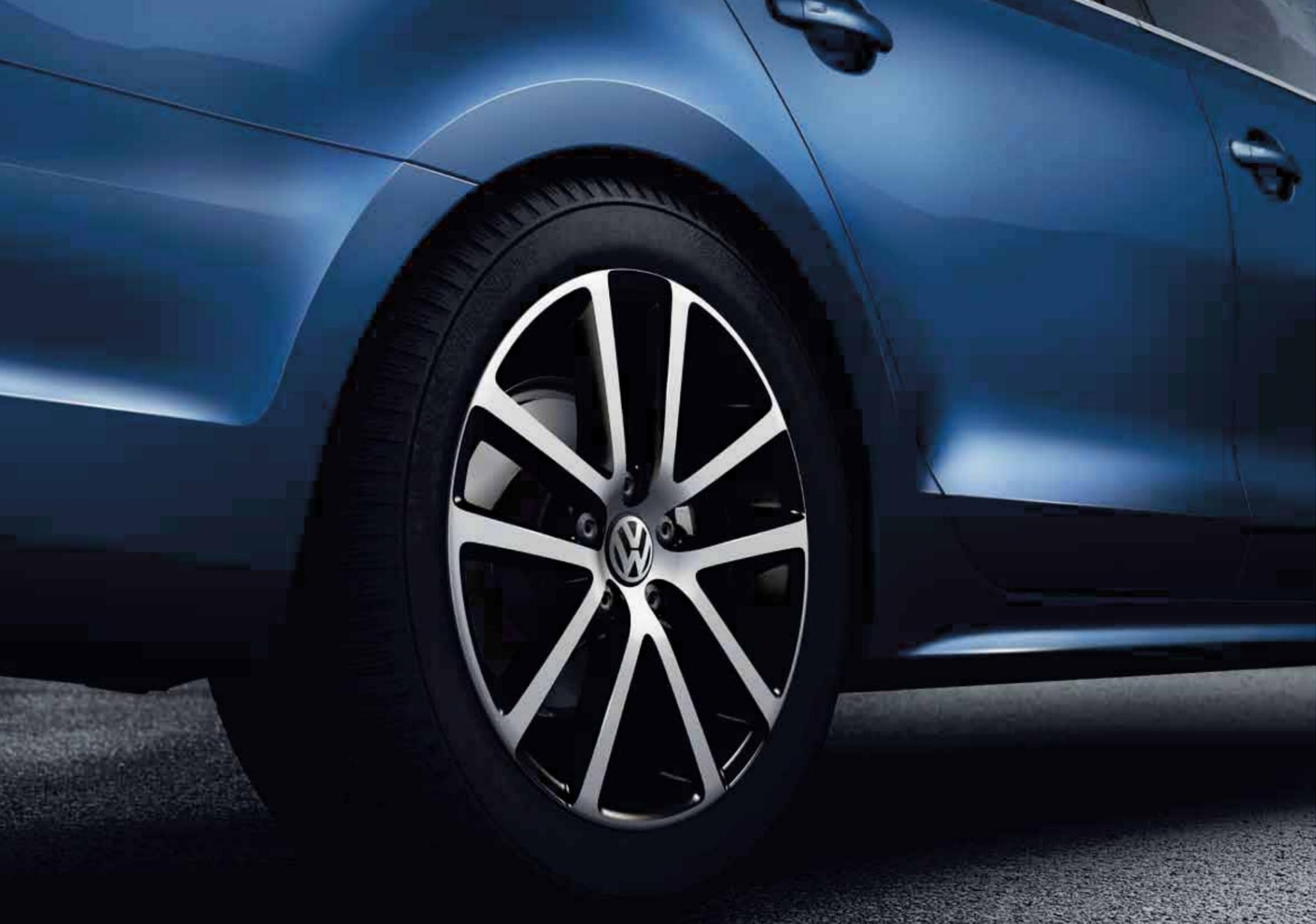
Resistente y muy similar visualmente a una llanta de aluminio, la **llanta de acero con diseño de 16 pulgadas con embellecedor de 7 radios**, está disponible en combinación con neumáticos 205/55 R16. | **A**
