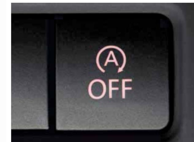
El sistema Start&Stop posibilita una conducción ahorrativa y con bajas emisiones contaminantes. Al detenerse en un atasco o ante un semáforo, basta con soltar el embrague y retirar la marcha o pisar el freno (en los modelos con cambio de doble embrague DSG), para que el motor se pare. Al reiniciar la marcha el motor arrancará de forma automática. | O
