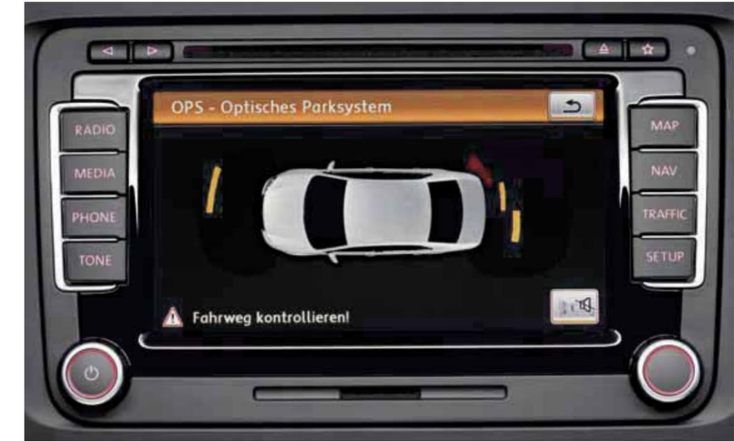
El **ParkPilot** con sensores de ultrasonidos en el parachoques delantero y trasero avisa con señales acústicas de los posibles obstáculos al estacionar: cuanto más se aproxime el vehículo a un obstáculo, tanto mayor será la frecuencia de los tonos. Incorpora OPD (Optical Parking Display) en la pantalla de la radio. | **O**
