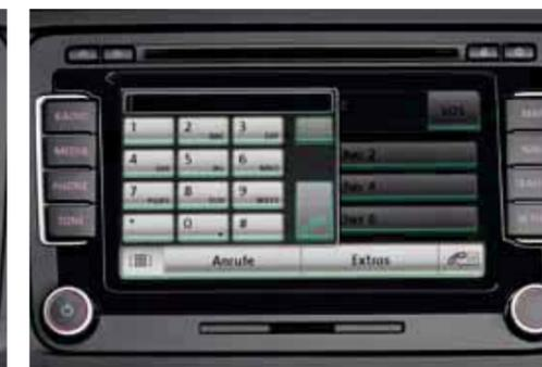
La **preinstalación de teléfono móvil VW Universal Bluetooth<sup>3)</sup>** es un dispositivo de manos libres que satisface los más elevados requisitos de confort. El móvil se conecta automáticamente al sistema del vehículo y de este modo puede permanecer, por ejemplo, en el bolsillo de la chaqueta. En combinación con RNS 310 y RNS 510 puede utilizarse la pantalla táctil para acceder a sus funciones. |O|S
