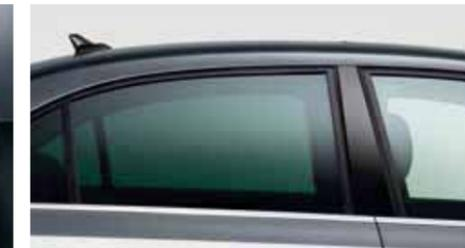
Las **ventanillas laterales posteriores oscurecidas** y la **luneta trasera oscurecida** reducen en hasta un 65% la radiación solar, contribuyendo así a mantener una temperatura agradable en el habitáculo. Además protegen a los ocupantes y al equipaje contra las miradas indiscretas. | **O**
