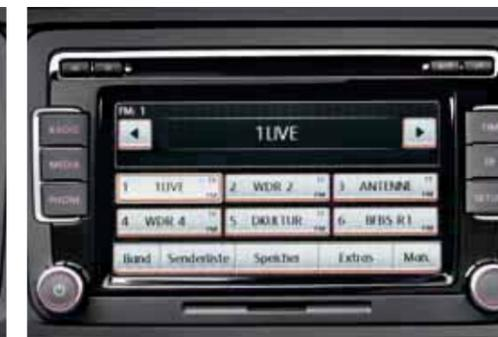
La pantalla en color de gran tamaño y con funcionamiento táctil de la **radio RCD 510<sup>2)</sup>**, facilita su uso. Del sonido se encargan los archivos mp3 y WMA, así como un cargador para 6 CD's incorporado, junto con la potencia de 4 x 20 vatios y los ocho altavoces. |O|S
