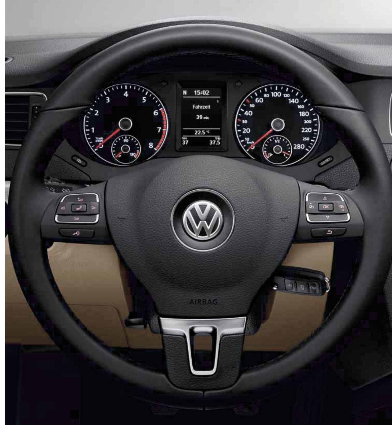
El volante multifunción en cuero convence por su extraordinaria facilidad de uso. Por ejemplo, se puede utilizar cómodamente el radio, el teléfono móvil y el ordenador de abordo por medio de sus botones. Además está forrado de cuero, un material natural con un tacto especialmente agradable que otorga un toque elegante al interior. |O|S
