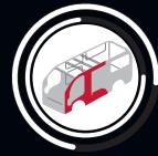
ZONAS DE DEFORMACIÓN PROGRAMABLE/ REFORZAMIENTO ESTRUCTURAL EN LOS COSTADOS DEL VEHÍCULO
