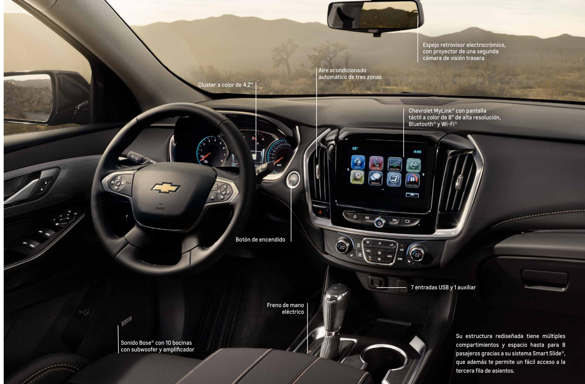
Espejo retrovisor electrocrómico, con proyector de una segunda cámara de visión trasera
